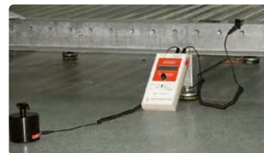
Procedimiento de medición de la resistencia a tierra de un pavimento antielectrostático.
