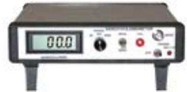
La carga electrostática en un material puede medirse vertiéndola en una Taza de Faraday. El nanoculombiómetro es un instrumento de amplio espectro capaz de medir niveles de carga de  $\pm 0,01$  nanoculombios.
