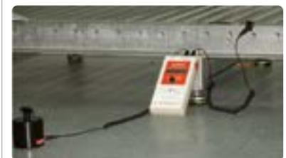
Procedimiento de medición de la resistencia a tierra de un pavimento antielectrostático.
