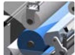
A la entrada de los tinteros hay presencia de vapores inflamables provocados por la evaporación del acetato de etilo. Las elevadas tensiones electrostáticas de estas bandas comporta el riesgo de cargas electrostáticas incendiarias que provoquen incendio.
