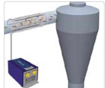
Sistema de ionización adecuado para la neutralización de materiales que se transportan neumáticamente. Las barras que integran el interior del tubo están contrafradas consiguiendo así que todo el material que circule por su interior quede totalmente libre de carga.
