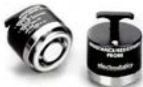
Medidor portátil y versátil para realizar mediciones rápidas y precisas de resistividad superficial, resistividad volumétrica o resistencia a tierra.
