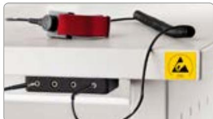
Conexión de masa para 4 terminales banana.
