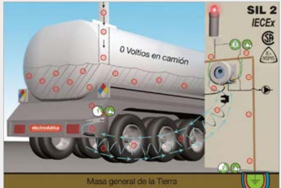
Sistema de verificación con tecnología patentada que reconoce que la pinza de puesta a tierra está conectada a la cuba del camión y garantiza que el trasvase no se inicie en caso contrario. Riesgos que minimiza: que la pinza no se conecte o se conecte a un elemento distinto de la cuba o se pierda la tierra.
