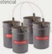
Pulpo de 4 pinzas (510.00102) con cable de acero trenzado o acero inoxidable con cubierta de nylon, para conexión equipotencial de 4 bidones en pallet. Distancia entre pinzas 1m.
