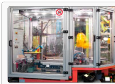
Las aplicaciones de las planchas de policarbonato varían desde la industria electrónica, la tecnología de la automatización, tecnología de Sala Limpia o la construcción de máquinas y plantas. Debido a su transparencia, son ideales para recintos de máquinas, cubiertas protectoras, sistemas de almacenamiento, etc.
