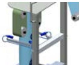
Las operaciones de conformación, llenado y sellado verticales suelen provocar rechazos en el paquete acabado debido a que la película del área de sellado atrae las aletas del producto. El montaje de una boquilla ionizadora justo debajo del tubo de llenado neutralizará las cargas electrostáticas, permitiendo un sellado limpio.
