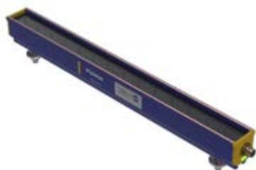
La barra antielectrostática VicinION está diseñada para neutralizar superficies. Está equipada con una fuente de alimentación de alto voltaje integrada, emisores y un LED de estado y se suministra con una fuente de alimentación de 24 V CC a través de un conector M8. La distancia óptima de trabajo es entre 5 y 75 mm
