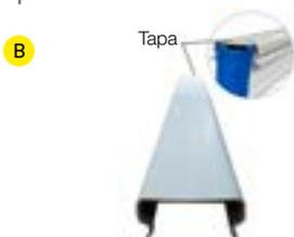
Tapa: permite cubrir partes de la barra generadora cuando ancho es menor que longitud efectiva, y evita arcos. Se puede cortar. Apta para Barras Tipo 1-6.
