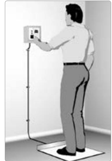
La puesta a tierra del personal se realiza mediante el calzado y/o muñequera, que en el caso del calzado puede tomar forma de zapato, taloneras o cubrezapatos.
