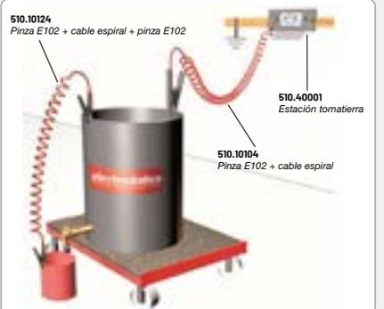
Puesta a tierra y conexión equipotencial entre bidones mediante pinzas con cable espiral.
