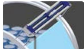
Con la reducción de grosor, la carga electrostática en el film cada vez que provoca mayores problemas. Algunos ejemplos son: tras el corte, el film tiene tendencia a seguir el rodillo de corte, o encaramarse en las guías a su salida, o levantarse a la salida de la rampa, o amarrarse en el volteador. La instalación de los equipos específicos para cada escenario permite resolverlos.
