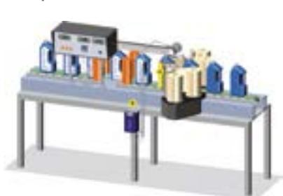
Al separarse la etiqueta del soporte esta se carga electrostáticamente produciendo que se amorre a la botella de forma inadecuada, arrugándose o bien desplazándose. Para evitarlo proyectamos aire ionizado desde el exterior de la etiqueta con una **barra MEB Air**.
