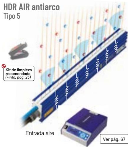
La barra generadora HDR AIR tiene un resistor acoplado a cada emisor para evitar arcos y facilitar un campo uniforme. Adecuada para trabajar en lugares con mucha humedad, en aplicaciones que requieren más de 30kV ó elevada velocidad. Al incorporar el aire, facilita el mantenimiento y mejora la limpieza de los equipos, a la vez que mejora la adherencia del material.
