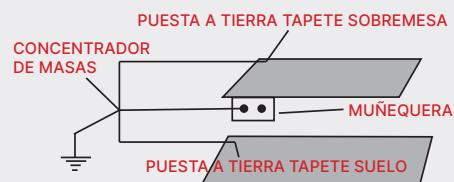
Figura 3. Croquis de instalación de la puesta a tierra del tapete, base para muñequera y alfombra suelo
