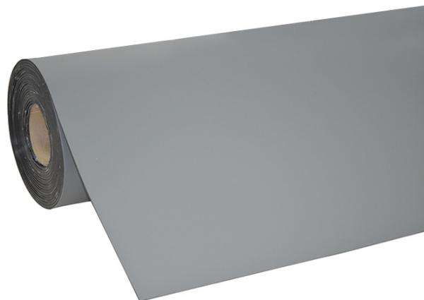
El material tiene dos capas para garantizar cuando se utiliza como tapete que la corriente circula por la cara inferior del tapete en vez de la superior que está en contacto con el dispositivo sensible a ESD, dado que la cara inferior negra, es conductiva electrostática y la superior gris, disipativa electrostática.
