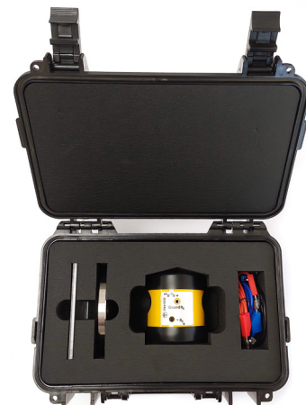
Kit de electrodo de doble anillo concéntrico en su maletín
