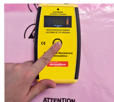
Fig. 6: Ensayo de resistividad superficial de un embalaje o verificación de una superficie, utilizando los electrodos internos
