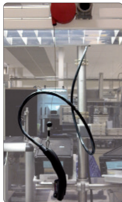
Detalle de la instalación de la pistola con un equilibrador
