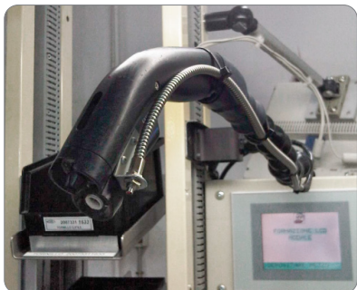
Pistola TopGun con sensor conectado a temporizador
