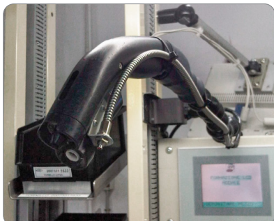
Pistola TopGun con sensor conectado a temporizador
