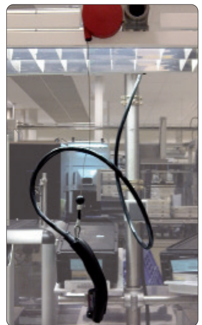
Detalle de la instalación de la pistola con un equilibrador
