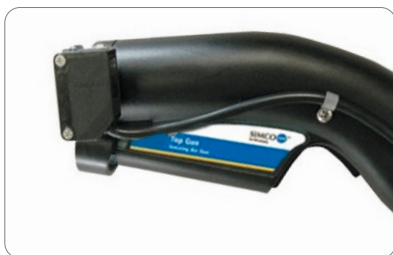
Detalle de la instalación del sensor sobre la pistola ionizadora en dos instalaciones diferentes
