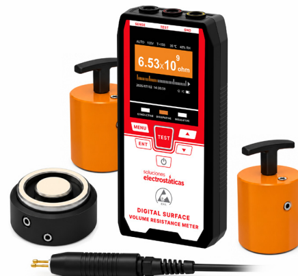
Imagen 1: 990.20023 con electrodos externos circulares
